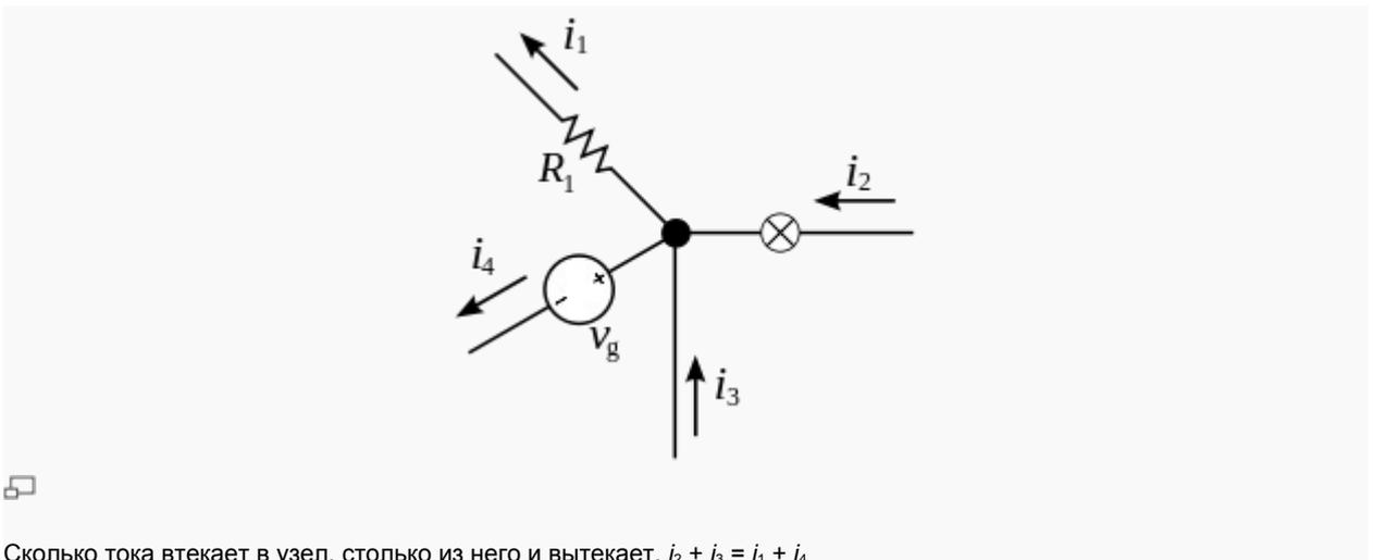
Первое правило Кирхгофа гласит, что алгебраическая сумма токов в каждом узле любой цепи равна нулю. При этом втекающий в узел ток принято считать положительным, а вытекающий — отрицательным:
